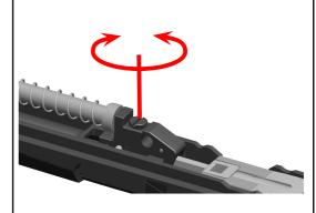
TURN ADJUST SCREW ACCORDING TO THE TREJECTORY
