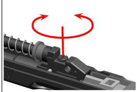
TURN ADJUST SCREW ACCORDING TO THE TREJECTORY
